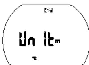
1. Подтвердить вход в режим нажатием . Высвечиваются установленные единицы (m / ft / °C / °F).
