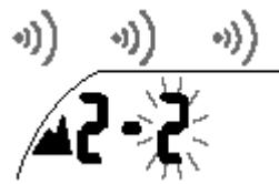
Если зафиксирован подъем на запрещенный высотный уровень, компьютер выдает сигнал опасности. **Действия:** Спуститься на безопасную высоту.
