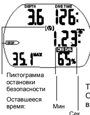
Таймер остановки безопасности (ОБ) показывает оставшееся время в течении которого дайвер должен оставаться на глубине ОБ в конце погружения. Таймер активируется дайвером и производит обратный отсчет интервала ОБ, начиная со значения предустановленного в программе SmartTrak. Таймер может быть перезапущен любое число раз. Диапазон: 1 - 5 минут (по умолчанию установлено 3 минуты).
