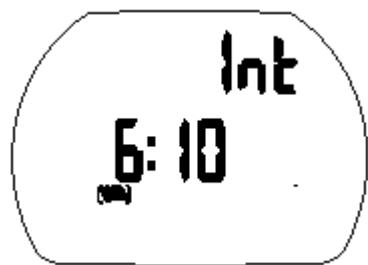
Из главного дисплея часов Вы можете перейти к индикации поверхностного интервала нажатием кнопки .
