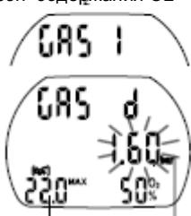
Глубина перехода на смесь ДЕКО (MOD для смеси D) соответствует максимально допустимому парциальному давлению кислорода (ppO<sub>2</sub> max), предустановленного вручную (->20, п. 5 установки MOD) или из программы SmartTRAK.
