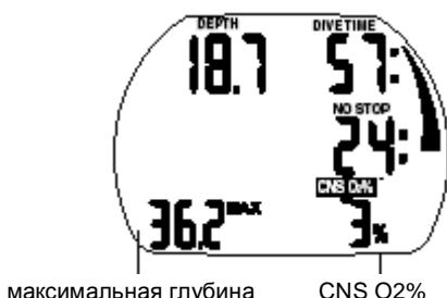
Показатель максимальной глубины высвечивается, если он превышает значение текущей глубины более, чем на 1 метр. Если показатель максимальной глубины не высвечивается, Аладин показывает температуру.
