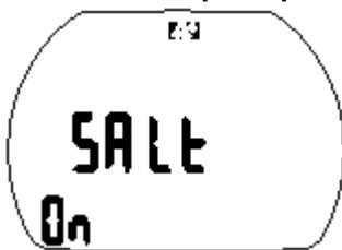
1. Подтвердить вход в режим нажатием . Статус Вкл./Выкл. Salt On – означает соленую воду, Salt Off – пресную.
