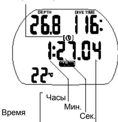
При погружении в режиме измерителя, АЛАДИН автоматически отслеживает время погружения и одновременно активирует секундомер-хронометр. Хронометр запускается максимум на 24 часа.
