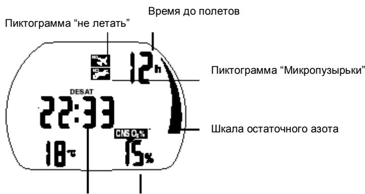
Из главного дисплея часов Вы можете перейти к индикации процесса дессатурации нажатием кнопки ⌂. Время дессатурации определяется токсичностью кислорода, насыщением тканей азотом или процессом образования микропузырьков. Время определяется по наибольшему из этих факторов. Через 5 секунд бездействия дисплей автоматически возвращается к **главному дисплею часов**.
