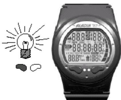
Компьютеры Аладин имеют режим подсветки экрана дисплея, который может быть активирован, как в подводном, так и в надводном состояниях.
