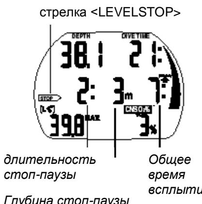
При входе в фазу стоп-пауз, стрелка-индикатор <NO STOP> гаснет и загорается стрелка <LEVELSTOP>(стоп-уровень). Аладин выдает акустический сигнал, а стрелка <LEVELSTOP> продолжает мигать 8 сек. Для завершения погружения без понижения уровня ПМП, необходимо выполнить всю последовательность предписанных остановок (стоп-пауз).
